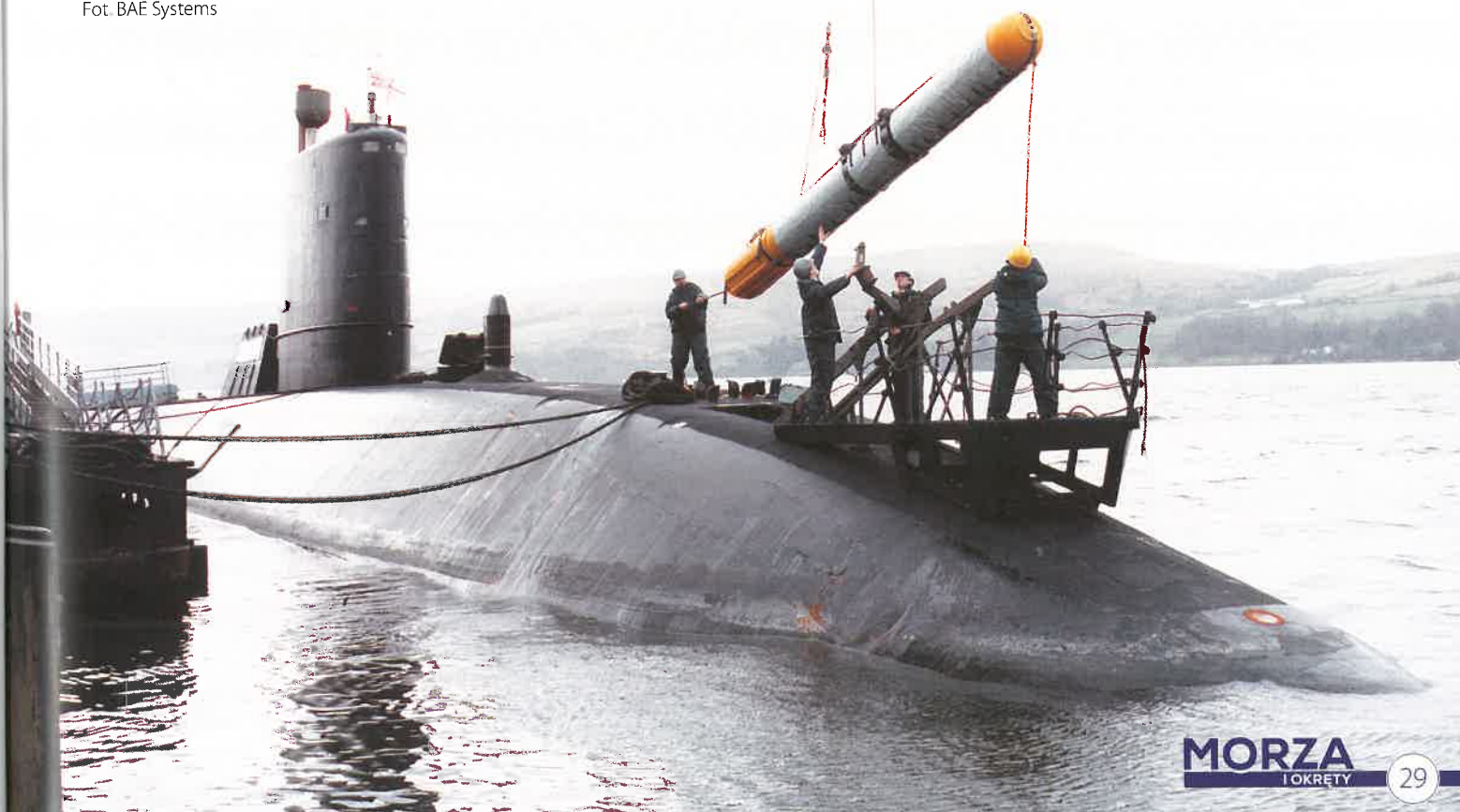
Łaładunek torpedy Mk 24 Spearfish na HMS Trafalgar . Zdjęcie z początkowego okresu służby, sprzed modernizacji i pokrycia jednostki powłoką anechemiczną. Fot. BAE Systems
