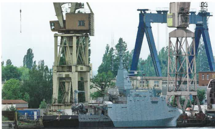
Kormoran przy nabrzeżu stoczni, trzy tygodnie przed pierwszym wyjściem w morze. Jednostka owinięta kablami demagnetyzacyjnymi. Fot. Tomasz Grotnik
