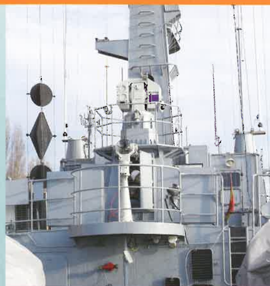
Głowica obserwacyjno-śledząca ZGS-158M i RSKO (poniżej) zamontowane na Kaszubie za masztem. Fot. PIT-RADWAR
