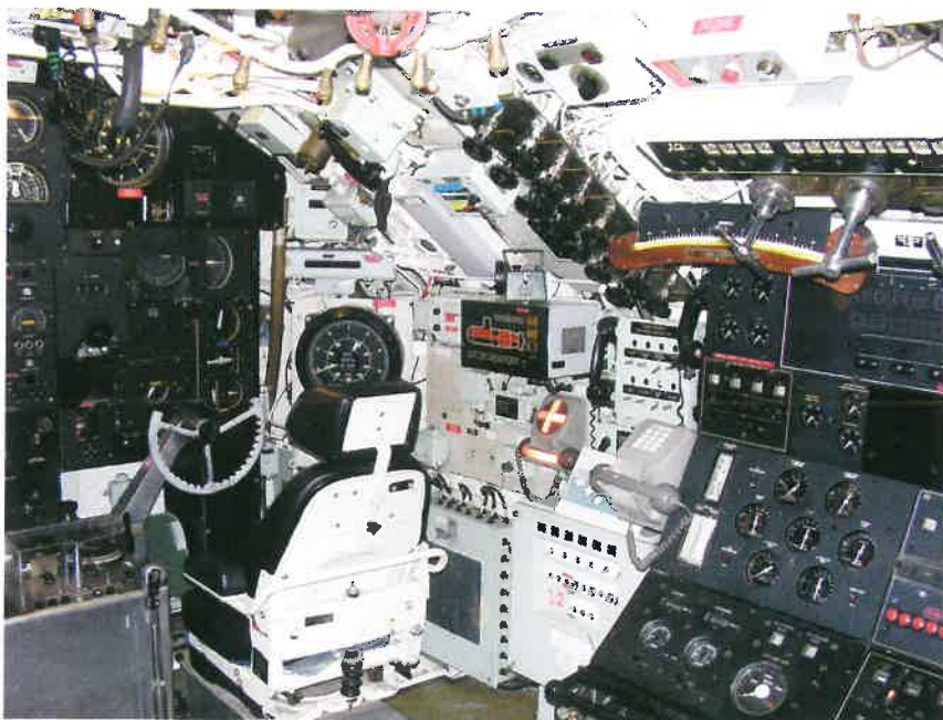
Wnętrze Courageousa – z lewej stanowisko sternika w centrali, obok przedział torpedowy z sześcioma wyrzutniami.
