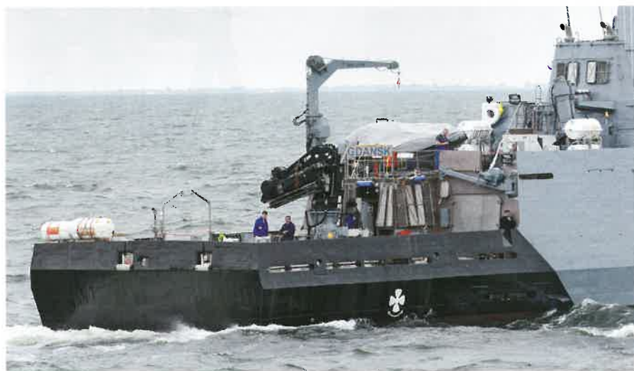
Rufowy pokład roboczy z żurawiem teleskopowym HIAB, za nim żurawik łodziowy, zaś nad wrotami hangaru na prawej burcie trzecia dźwignica – do wodowania pojazdów przeciwminowych Głuptak . Fot. Tomasz Grotnik
