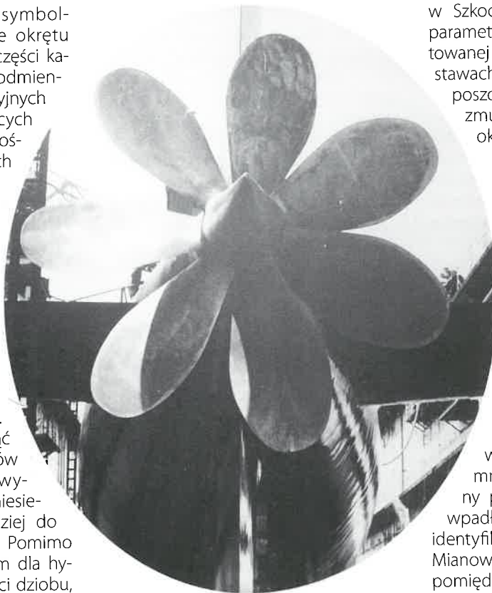
Siedmiskrzydłowa śruba napędowa jednostek typu Valiant . Fot. RN Submarine Museum
