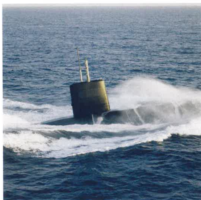
Okręty typów Dreadnought , Valiant i Churchill , aby rozwijać wysoką prędkość na powierzchni, musiały mieć trym na rufę. Na zdjęciu Courageous .
