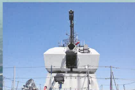
AM-35 na Kaszubie w czasie prób w morzu. Z prawej strony wieży widać radar pomiaru prędkości początkowej pocisków. Fot. Piotr Sikora
