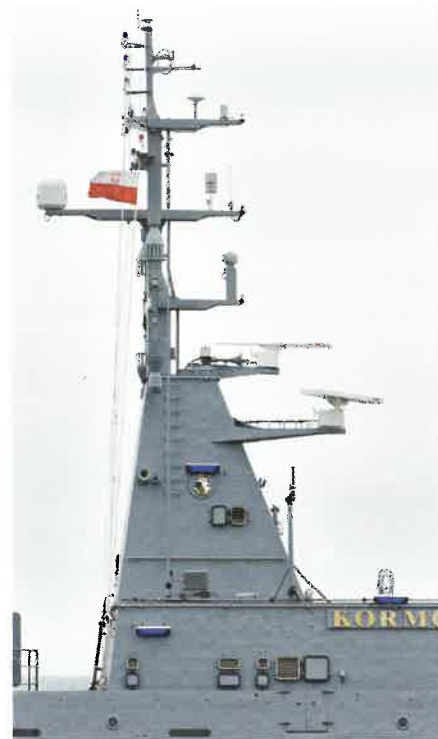
Maszt okrętu z antenami i czujnikami urządzeń elektronicznych. Fot. Tomasz Grotnik
