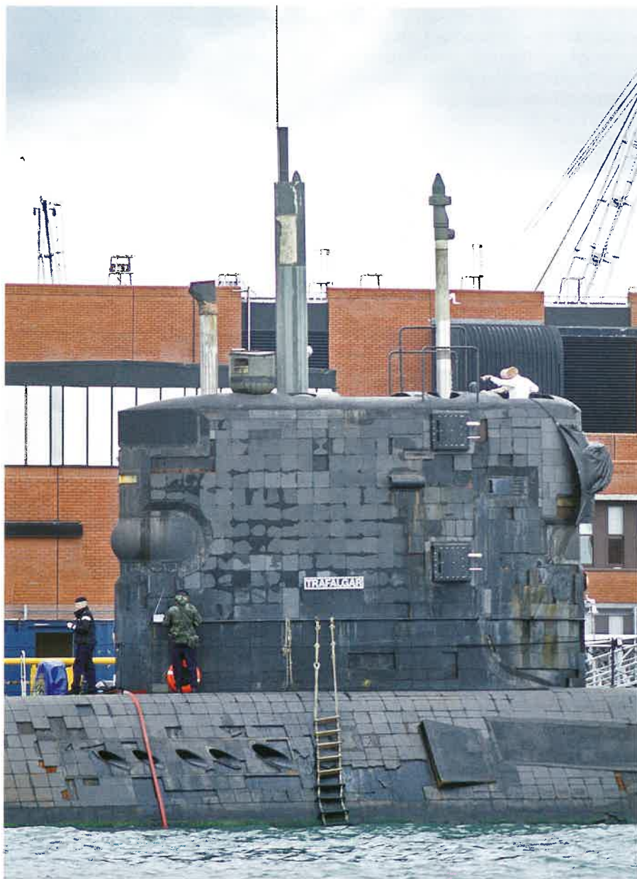
Zbliżenie kiosku Trafalgara po modernizacji. Na Zachodzie wyśmiewano Rosjan za nieumiejętność mocowania pokryć anechoicznych i odpadanie ich kostek z okrętów podwodnych ZSRR. Jak widać, Brytyjczycy nawet współcześnie mają z tym problemy.
