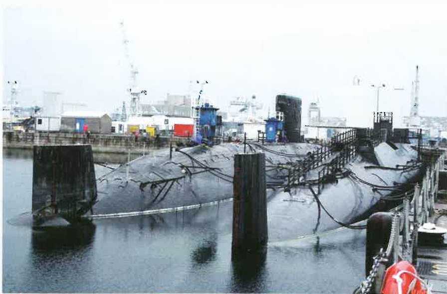
Do tej pory żaden atomowy okręt podwodny Royal Navy nie został całkowicie zutylizowany. Na zdjęciu jednostki typów Valiant (z prawej) i Swiftsure . Na tym drugim widać górną część dyszy pędnika strugowodnego.
