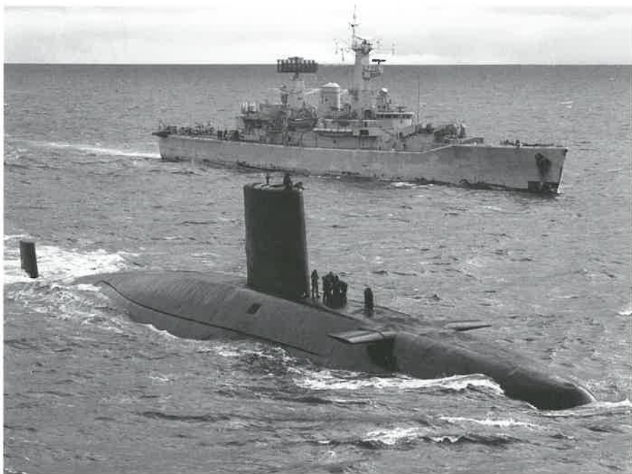
Pierwszy seryjny SSN Royal Navy – Valiant . Tu, w towarzystwie fregaty Penelope w trakcie wojny falklandzkiej. Stery dziobowe nie były już składane – umieszczono je wyżej na kadłubie, a ich rozpiętość nie przekraczała szerokości okrętu, co stanowiło wystarczającą ochronę przed uszkodzeniem.
