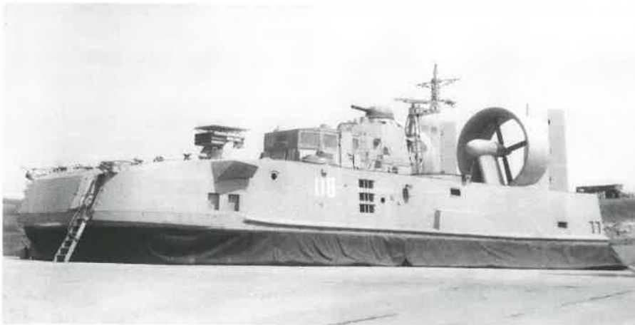
Kolejny „biały kruki” wśród czarnomorskich poduszkowców – kuter wsparcia ogniowego desantu AK-16 projektu 1238 Kasatka . Widać podniesioną do położenia bojowego wyrzutnię rakiet niekierowanych systemu Ogori kal. 140 mm, wieżyczkę Utios-M z wkm-em i granatnikiem 30 mm Plamia oraz armatę AK-306 kal. 30 mm.
